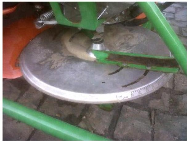
Figura 1: Disco distribuidor adubo, componente estudado. Fonte: Cedido por Stara
